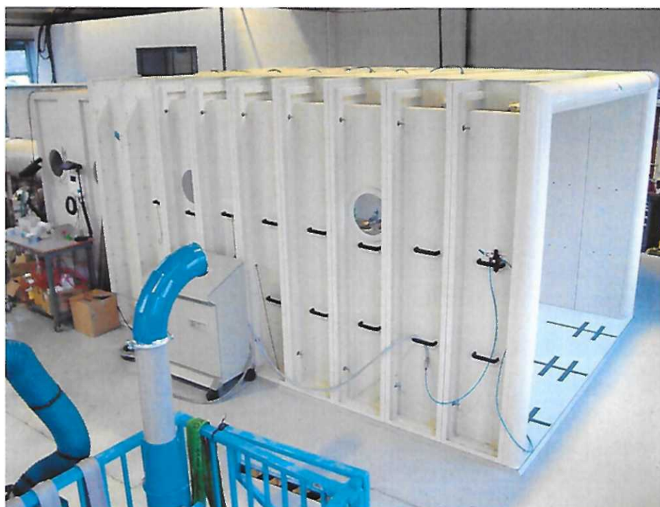
Figuur 5. Geventileerde open cabine die werd gebruikt voor de tests
